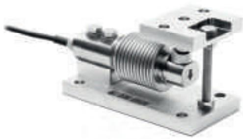
Montagesatz mit einzelner Abhebesicherung und Kompensation der Seitenkräfte für Biegestab- Wägezellen Serie FXC und FXD bis 500 kg. Ausgestattet mit einem Kugelgelenk für die Hochpräzisions-Wägung.
