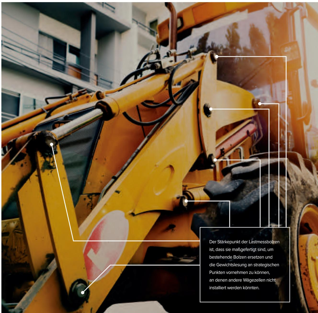
Der Stärkepunkt der Lastmessbolzen ist, dass sie maßgefertigt sind, um bestehende Bolzen ersetzen und die Gewichtlesung an strategischen Punkten vornehmen zu können, an denen andere Wägezellen nicht installiert werden könnten.
