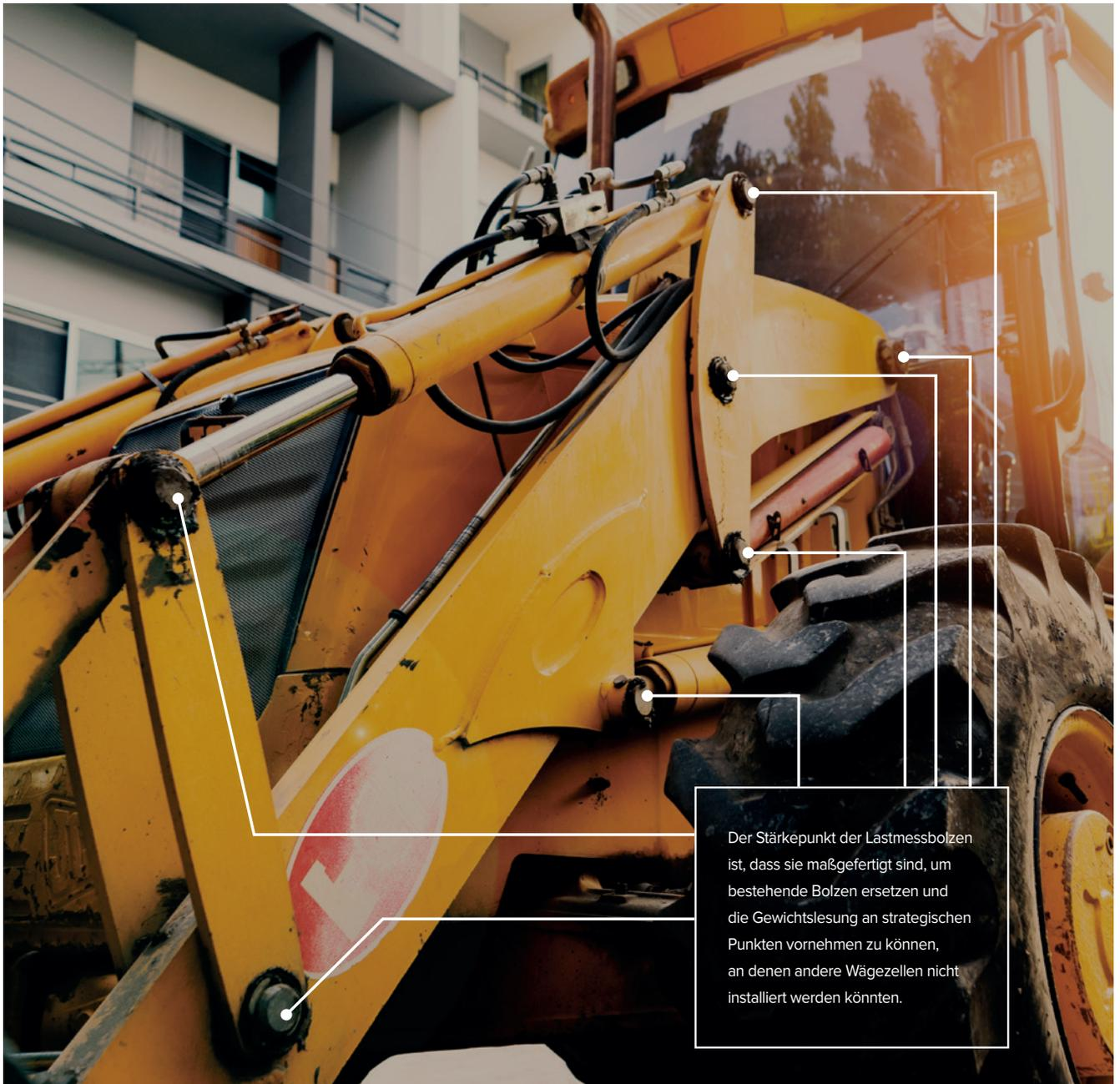
Der Stärkepunkt der Lastmessbolzen ist, dass sie maßgefertigt sind, um bestehende Bolzen ersetzen und die Gewichtlesung an strategischen Punkten vornehmen zu können, an denen andere Wägezellen nicht installiert werden könnten.
