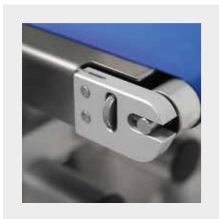
EINSTELMECHANISMUS DES TRANSPORTBANDS MIT „SPEICHERFUNKTION“ ZUM ERLEICHTERTEN AUSTAUSCH DES LAUFBANDS
