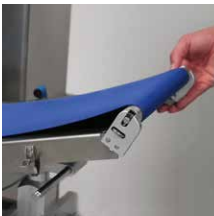
SYSTEM ZUR SCHNELLEN DEMONTAGE DER TRANSPORTBÄNDER
